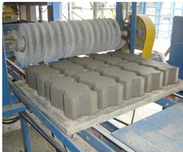
Fabricação com máquinas vibro-compressoras
