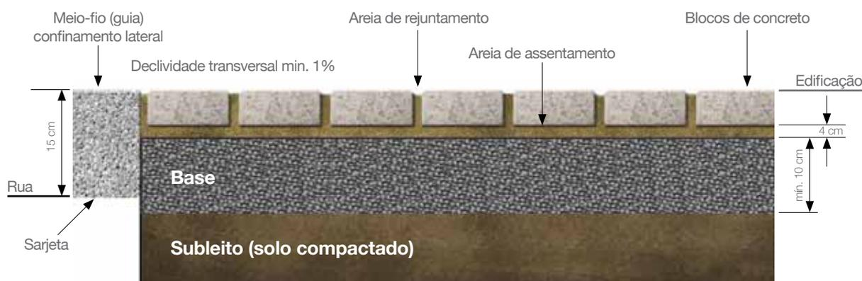
As peças de concreto têm que ter dimensões uniformes, compactação adequada de todo o conjunto e juntas pequenas entre elas, preenchidas com areia fina. Se as peças não forem uniformes não se conseguirá o assentamento adequado. As juntas devem ter abertura em torno de 3 mm e estar sempre preenchidas com areia.
