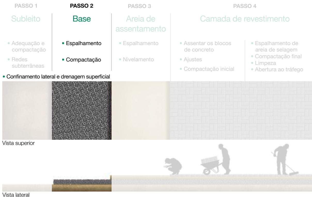
Normalmente, usa-se bica corrida, desde que tenha sido corretamente especificada, tomando-se precauções rotineiras para evitar a segregação do material durante o transporte, descarga e espalhamento. Depois disso, os principais aspectos da construção que justificam atenção incluem a regularização e a compactação da camada de base.
