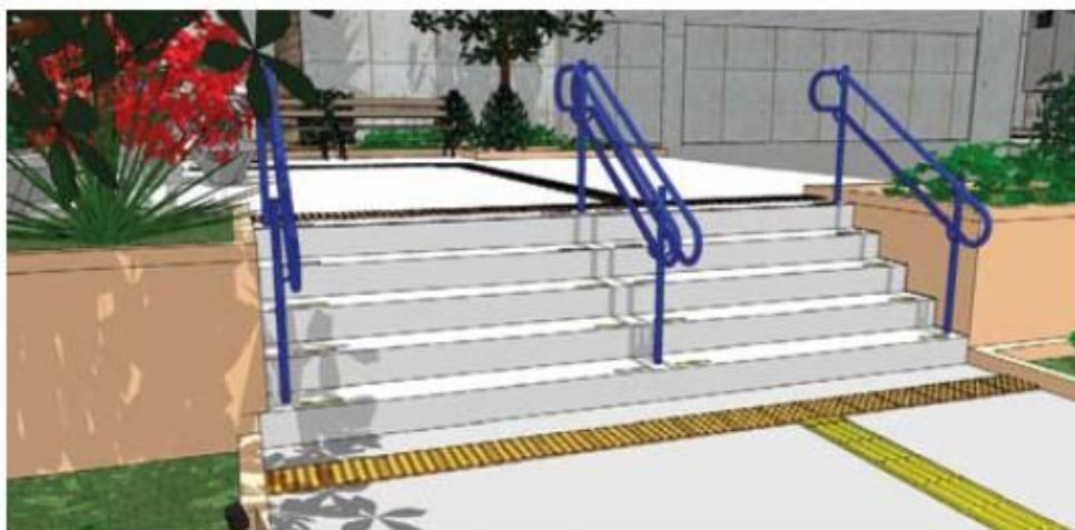
Figura 57 – Vista de escada com corrimão central
