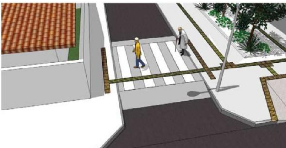
Figura 40 – Faixa elevada para travessia de pedestres
