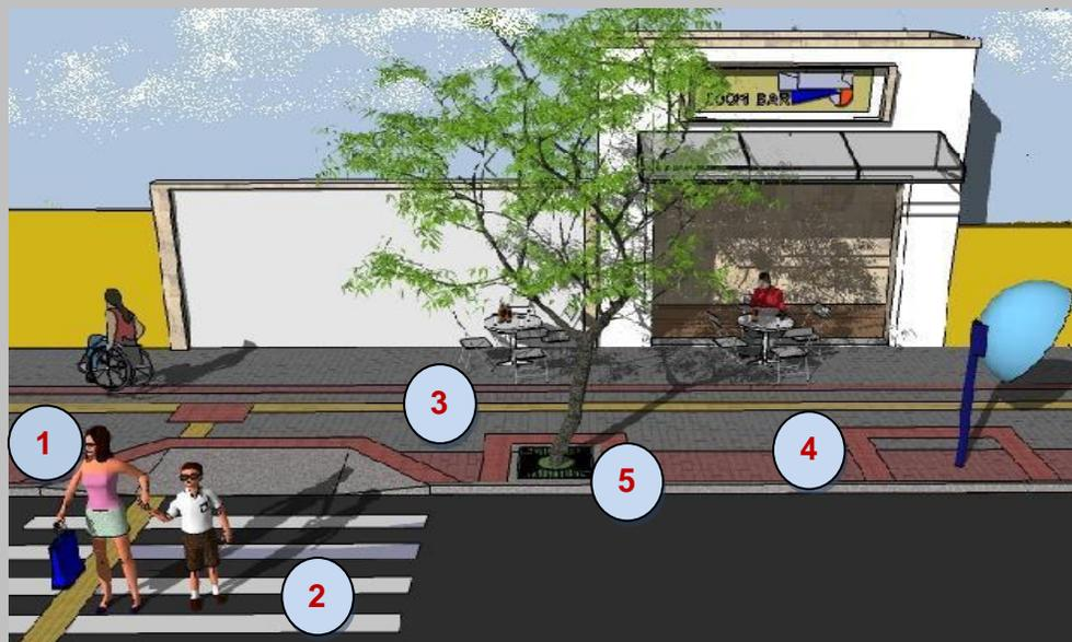
**1 - Rampa construída junto à faixa de travessia de pedestre:** largura mínima 1,20m; declividade máxima 8.33%; piso com textura diferenciada da existente no passeio. Material recomendado: concreto.
