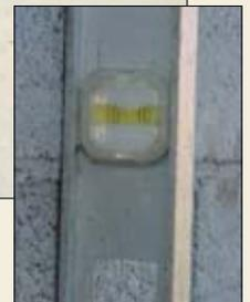
Usada para verificar o prumo e nível da alvenaria durante o assentamento dos blocos. É também utilizada na verificação da planicidade da parede. Esta régua substitui o prumo de face (fig. 17).
