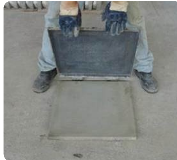
Processo produtivo utilizando fôrmas individuais de concretagem
